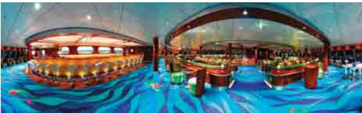
Abb. 54 Qualitativ hochwertige Leichtbauplatten mit herkömmlichem hochglänzenden Holzfurnier gefertigt und mit Sikaflex®-292 verklebt
