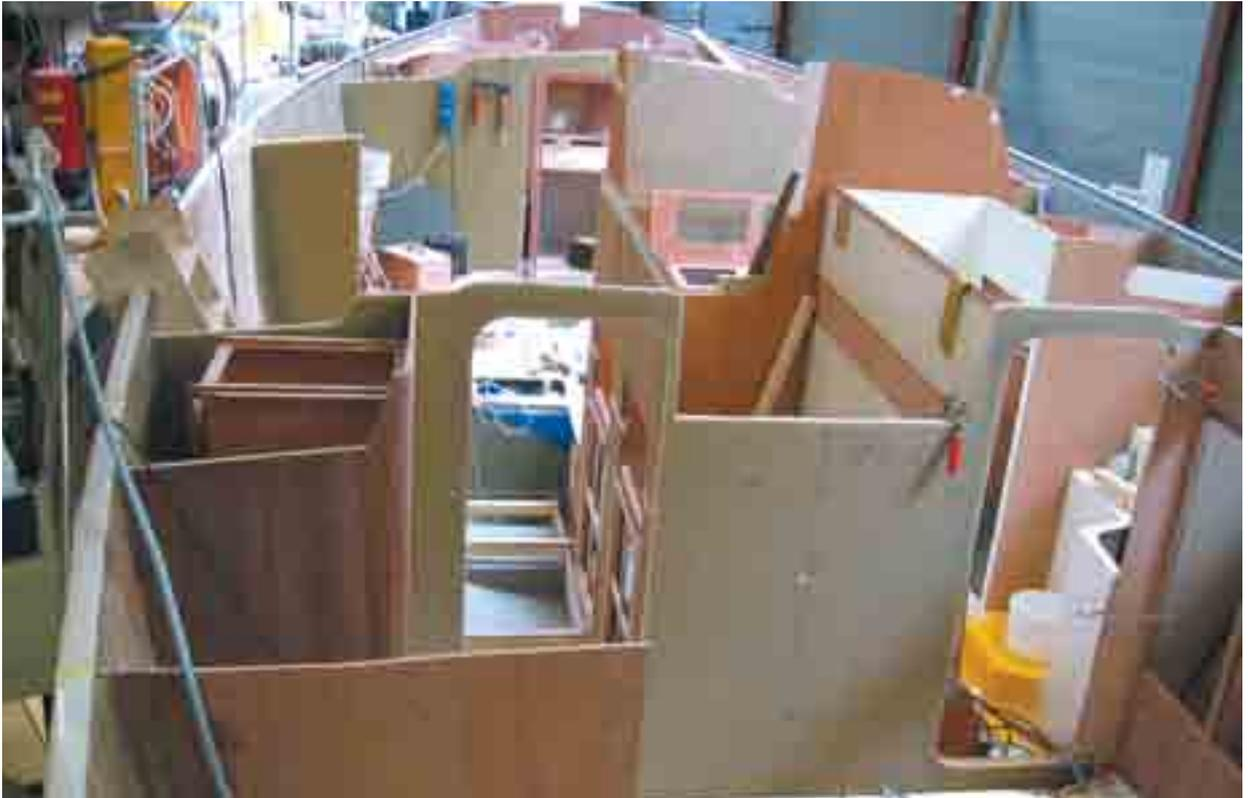
Abb. 55 Leichtbauplatten werden an einen offenen Schiffsrumpf angebracht
