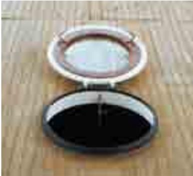
Abb. 21 Eine mit Sikaflex® verklebte und abgedichtete Backbord-Luke
